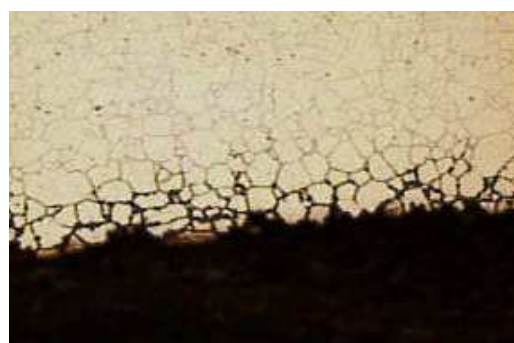
สนิมที่เกิดขึ้นกับผิวของหลังคาเหล็ก
